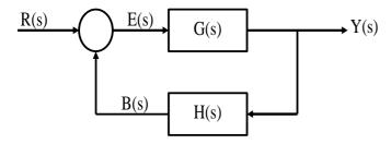
Considerando o diagrama de blocos apresentado, que modela um sistema de controle de um equipamento termodinâmico, é correto afirmar que a função de transferência do canal de realimentação é
